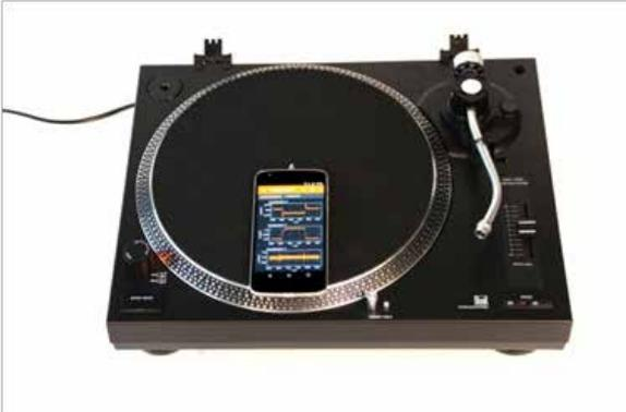
**Abb. 1:** Mit seinen integrierten Sensoren kann das Smartphone Beschleunigung und Kreisfrequenz auf dem Plattenspieler messen.
